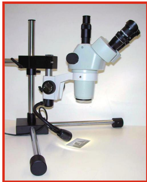
Universalstativ in Leichtbauweise mit 90°-Winkelarm und Stereomikroskop SPZT-50
